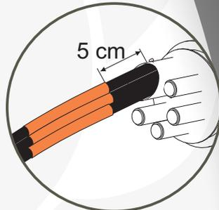
7.5. Seguido a esto ingrese el cable de fibra óptica en la cubierta; Recuerde asegurar el miembro central del cable y la chaqueta a los componentes que dispone el producto; Luego contraiga el tubo termocontráible con una pistola de calor.
