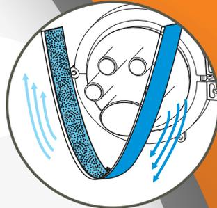
7.4. Introduzca en el cable de fibra óptica el tubo termocontráible a usar según el puerto seleccionado, (El termocontráible de menor diámetro es para el puerto circular y el de mayor diámetro es para el oval); Recuerde instalar los foil de aluminio en el cable.
