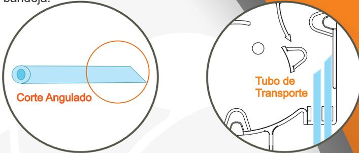
7.11. Ingrese los hilos de fibra optica al interior del tubo de transporte; después de haber ingresado los hilos, procesa a instalar los tubos en la bandeja de empalme. (Recuerde que el corte angulado queda en el interior de la bandeja).
