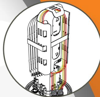
7.7. Luego realice la apertura del velcro y seleccione la bandeja que desea operar; Después retire el acrílico de contención y protección de los hilos.
